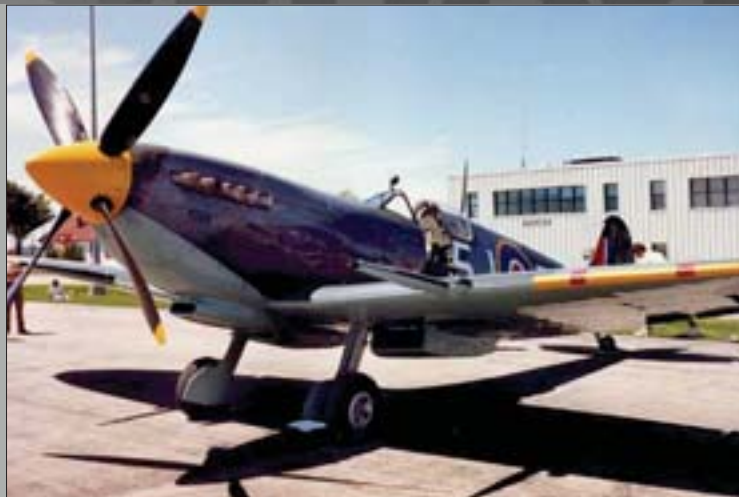
Потпуно различита концепција наоружања: монтирано у крилима код Spitfire (четири 7,7 мм и два 20 мм) – лево и у трупу код Messerschmitt Bf-109F (два 7,9 мм изнад мотора и један 20 мм који гађа кроз осовину елисе) – десно. Овај Bf-109F запленили су Британци и скинули мотор током прегледа.
