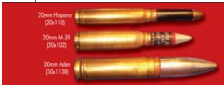
Муниција 20 мм Hispano, 20 мм са топа М39 и 30 мм са топа Aden
