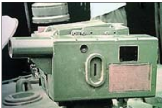
Сасвим нов систем ласерског заслепљивања - ометач ЗМ-87
